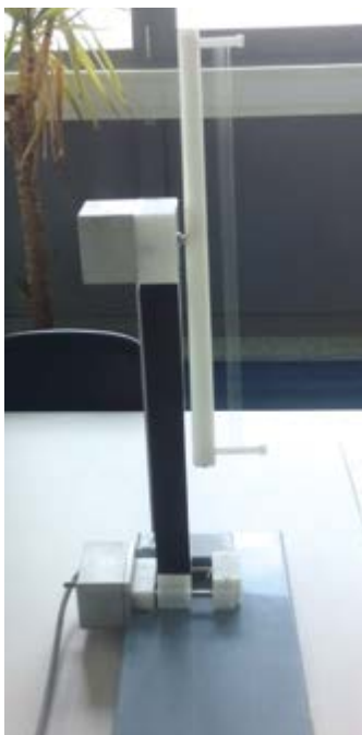
Abbildung 3 Aufbau zur Gewinnung von Spinnenseide.
